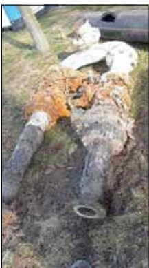
Ausgebaute Druck- leitungen
